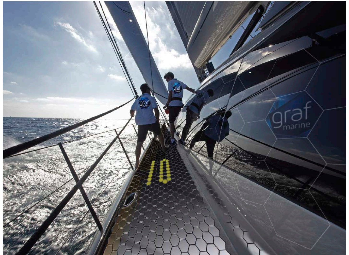
Mae Grafmarine (y Ganolfan OpTIC yn Llanelwy) yn datblygu system cynhyrchu ynni solar a storio trydan integredig ar gyfer unrhyw arwyneb gwastad i greu a storio ynni.
