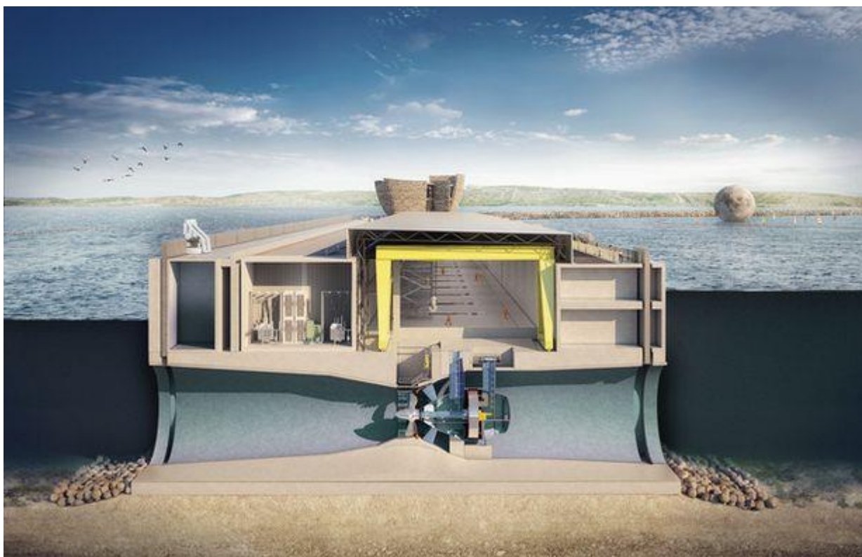
Ffigur 3. Trawsdoriad o Lagŵn Llanw Bae Abertawe. Delwedd o Tidal Lagoon Power.
